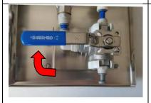
Karbonator ausschalten, damit er nicht einspritzen kann! Vergewissern Sie sich, dass alle Schläuche der Schankanlage angeschlossen und die Zapfhähne geschlossen sind.
