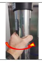
Tragen Sie das heutige Datum am Aufkleber ein. Schrauben sie nun die neue WW Easy Change Cartridge bis zum Anschlag rein. Achten sie darauf, dass der Spülschlauch in den Eimer ragt.
