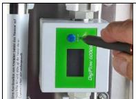
Durch Drücken der blauen "Display" Taste wird der Zählerstand angezeigt. Zählerstand des Literzählers bitte in die Serviceliste im Deckel eintragen.
