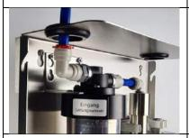
Schließen Sie die GASTRO V11 mit einem John Guest kompatiblen und für Trinkwasser zugelassenen 1/2" Schlauch an das Trinkwassernetz und den Karbonatoreingang an. JG Sicherungsclipse anbringen.
