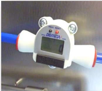
elektronischer Literzähler zur Kontrolle der insgesamt gezapften Wassermenge und Wartungsintervalle
