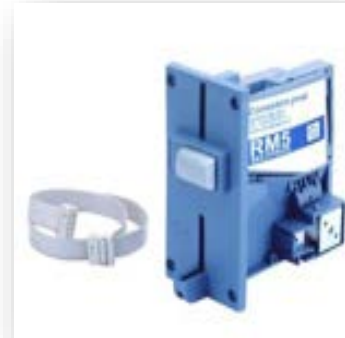
intelligenter Münzprüfer jeweils 3 Paare induktive und optische Sensoren Mechanische und elektronische Anti- Fishing- Vorrichtung, ...
